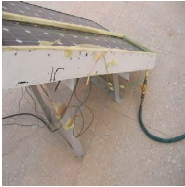
Vue du capteur hybride PV/T et du module témoin
