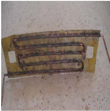
Vue de la plaque en cuivre et du serpent (système thermique)
