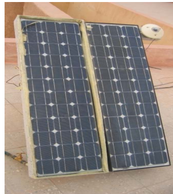
Vue du capteur hybride PV/T et du module témoin
