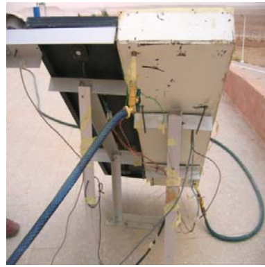
Vue du capteur hybride PV/T en expérimentation
