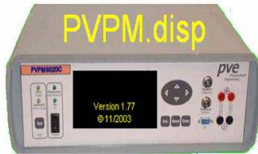
Fig. 2: Charge électronique pour caractérisation
