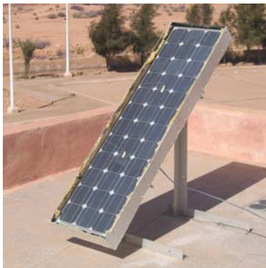
Vue du capteur hybride PV/T
