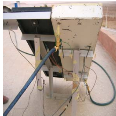
Vue du capteur hybride PV/T en expérimentation
