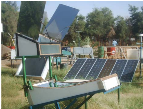
Fig. 3: Vue représentant le prototype cuiseur solaire à double exposition sur banc d'essai expérimental, 'URER/MS', Adrar
