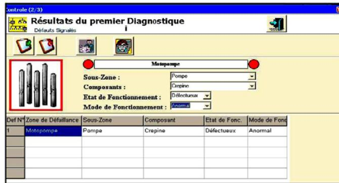
Fig. 20: Résultat du premier diagnostic et initialisation du cycle RàPC
