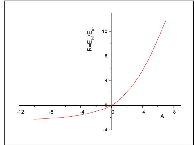
Fig.3: Rapport de l'énergie d'interaction sur l'énergie cinétique en fonction  $A$ . On constate que, pour des interactions très intenses, ce rapport tend vers  $\infty$ .
