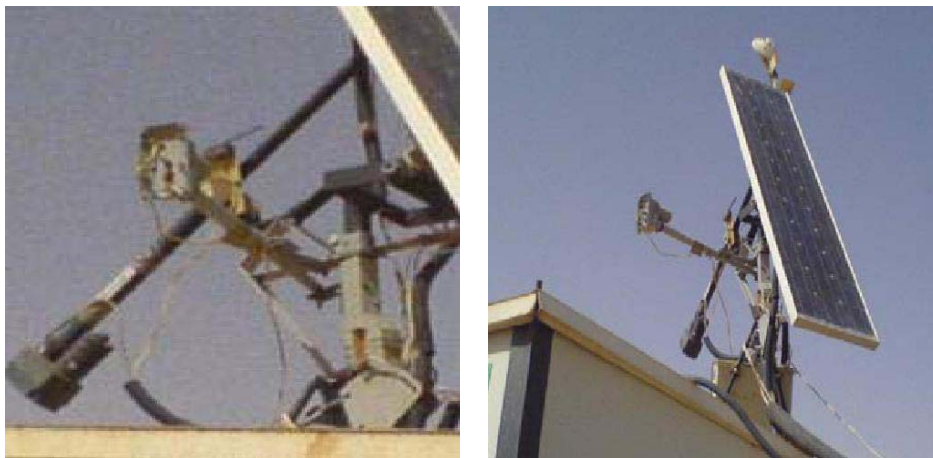
Fig. 4: Vue du système suiveur de soleil en fonctionnement
