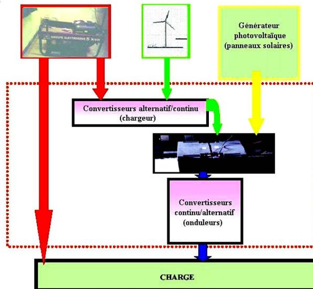
Fig. 1: Schéma physique de la chaîne de conversion d'énergie électrique hybride (photovoltaïque- éolienne- groupe électrogène)
