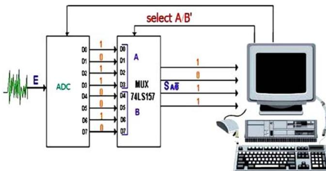
Fig. 6: Système d'acquisition réalisé
