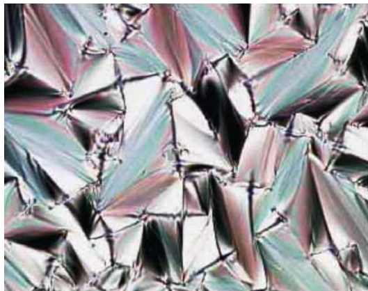
Fig. 10: Photographie de la texture du mélange précurseur 7 % prise en phase SmA (X 320)
