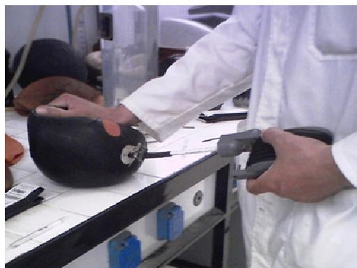
Photo 5. Le DRAGER : Dispositif de mesure du %  $H_2S$
