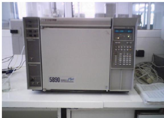
Photo 6. Chromatographe pour estimer le Pouvoir Calorifique du biogaz
