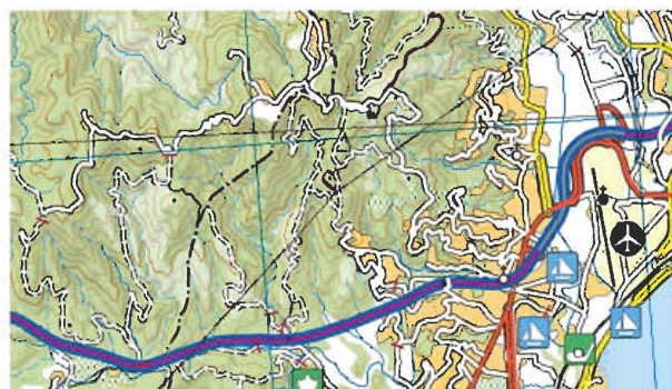
Fig. 4 Généralisation et placement des écritures A gauche : La BDCarto® représentée au 1:100 000 avec des problèmes d'empatement de virages, de superpositions de routes et de toponymes à placer A droite : La Top100 après généralisation et le placement automatique des écritures.
