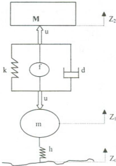
Fig. 5 : Modèle de la suspension active (1/4) de Véhicule
