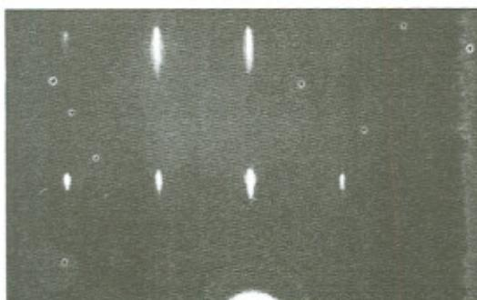
Figure 6: Cliché de diffraction RHEED de la surface des couches minces de ZnO déposées sur la face  $(11\bar{2}0)$  de  $\text{Al}_2\text{O}_3$ .
