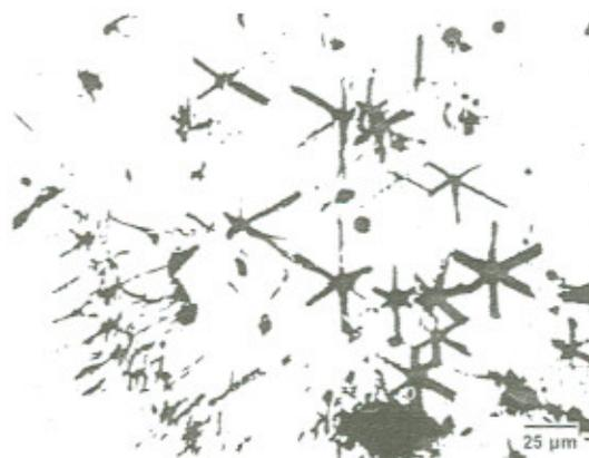
Figure 2: Microphotographie optique montrant des veinules de Zn métallique dans des couches minces de ZnO, d'épaisseur 2 µm, déposées sur un substrat en Al<sub>2</sub>O<sub>3</sub> d'orientation (0001).
