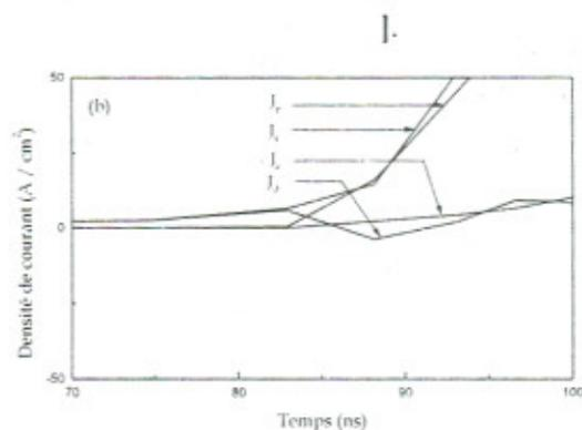
Figure 4. Evolution temporelle de la densité de courant total  $J_t$ , de la densité de courant de conduction électronique  $J_e$  et ionique  $J_i$  et de la densité de courant de déplacement  $J_d$  à la cathode.
