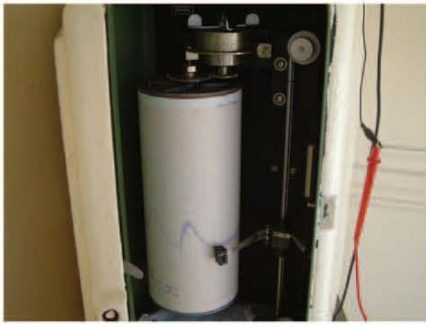
Figure 5: Tambour d'enregistre du marégraphe analogique (Tsunami du séisme di 21 mai 2003)
